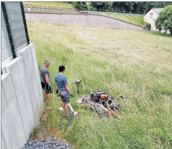
Mitarbeiter der Fa. Boden Kuntze GmbH aus Kleinschönberg führen in Garsebach die Baugrunduntersuchung für eine geplante Bahnquerung durch.
