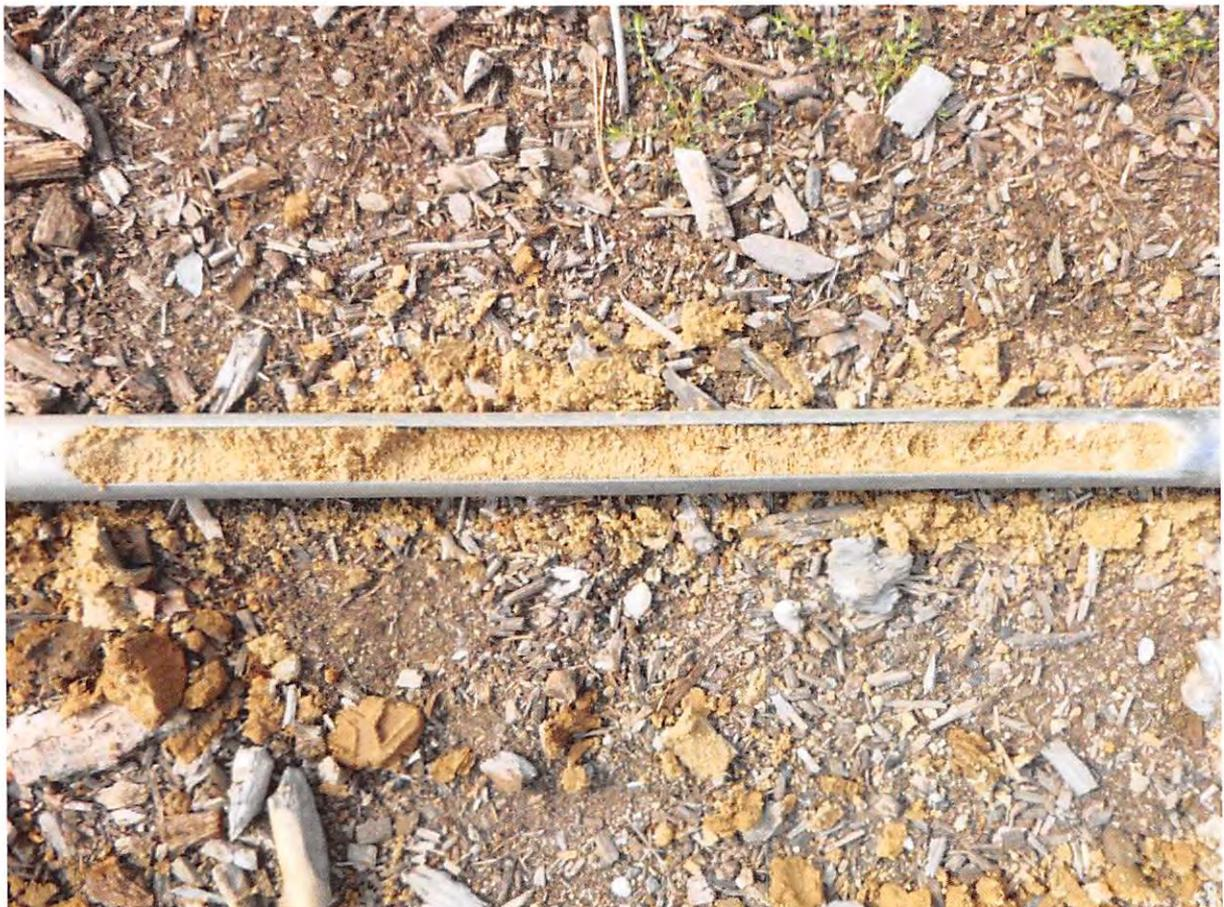
Bild 6: Tieferer Bereich bei 4,5-5,0 m, Mittelsand, schwach kiesig.
