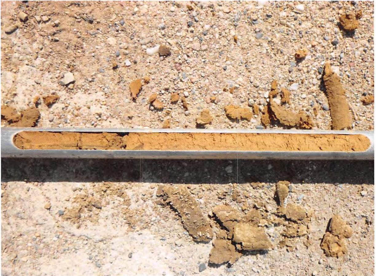
Bild 5: Bohrung 3, Bereich 1,5-2,0 m, Schluff, feinsandig.
