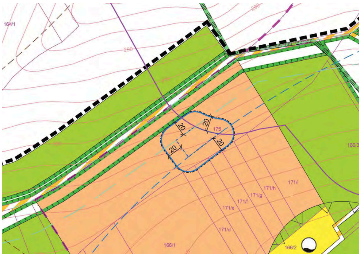
Abbildung 3: Methodik zur Festlegung Baufenster 1
