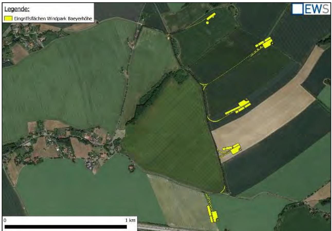
Abbildung 5: Direkte Eingriffsflächen (temporär oder dauerhaft) durch den Bau des Windparks Baeyerhöhe (zu verbreiternde Wege und/oder WEA-Standorte inkl. Kranstell- und Montageflächen)
