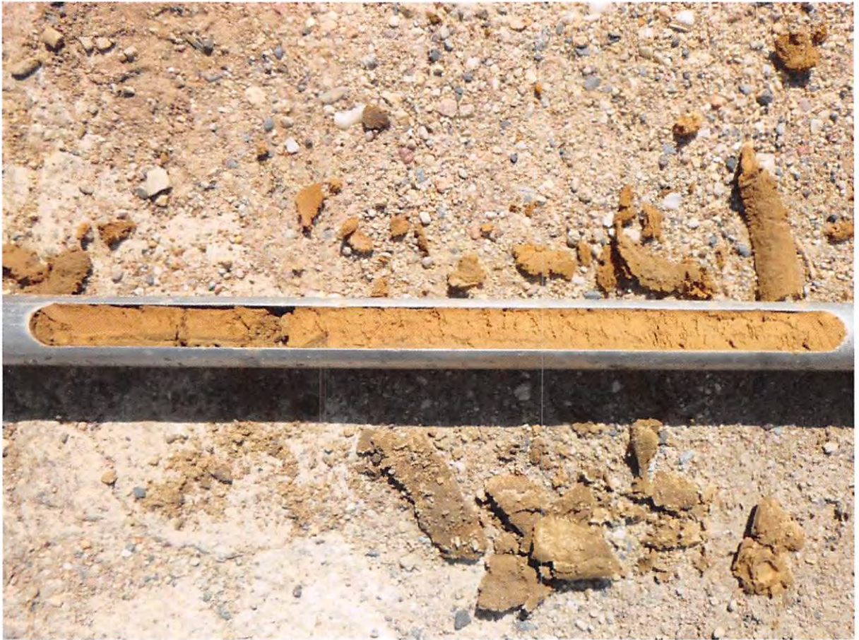
Bild 5: Bohrung 3, Bereich 1,5-2,0 m, Schluff, feinsandig.
