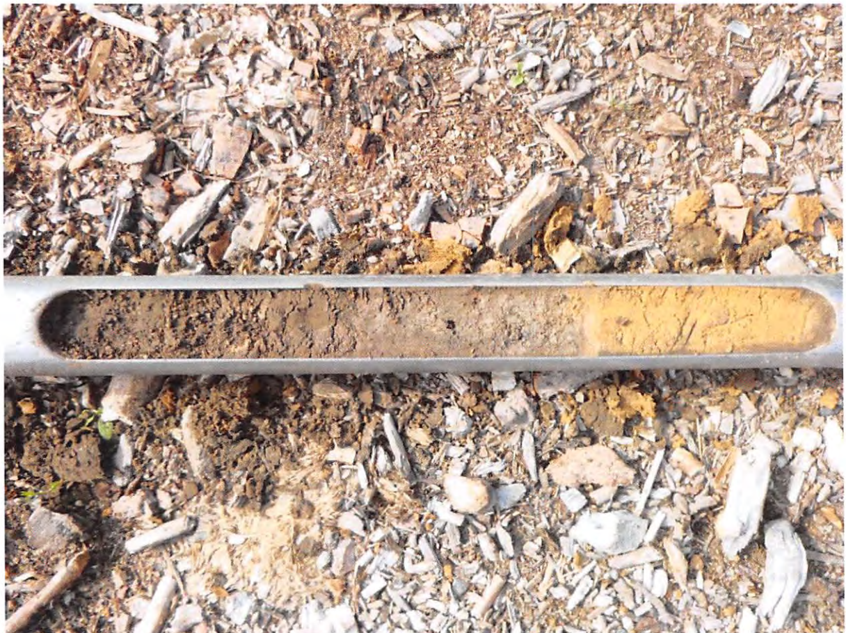
Bild 4: Bohrung 1, Bereich 0,5-1,0 m, Schluff, feinsandig, Auffüllungen bis 0,8 m.
