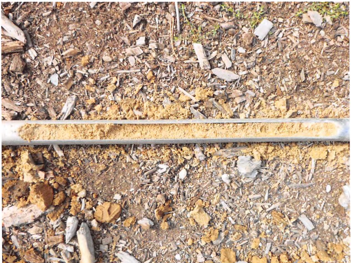
Bild 6: Tieferer Bereich bei 4,5-5,0 m, Mittelsand, schwach kiesig.
